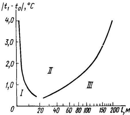
Рис.2. Области теплового влияния техногенных нарушений в зависимости от размеров нарушенного участка  $l$  и разности среднегодовых температур поверхности грунтов в нарушенных  $t_1$  и естественных  $t_0$  условиях
