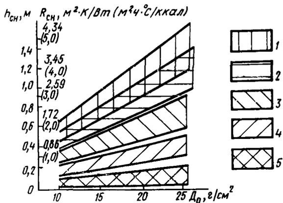
Рис. 4. Зависимость мощности снега  $h_{сн}$  и термического сопротивления  $R_{сн}$  в различных типах природных микрорайонов от нормы количества снега  $D_0$
