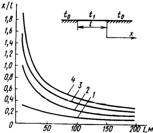
Рис.1. Зависимость размеров зоны теплового влияния техногенных нарушений  $x$  от ширины полосы нарушения  $l$
