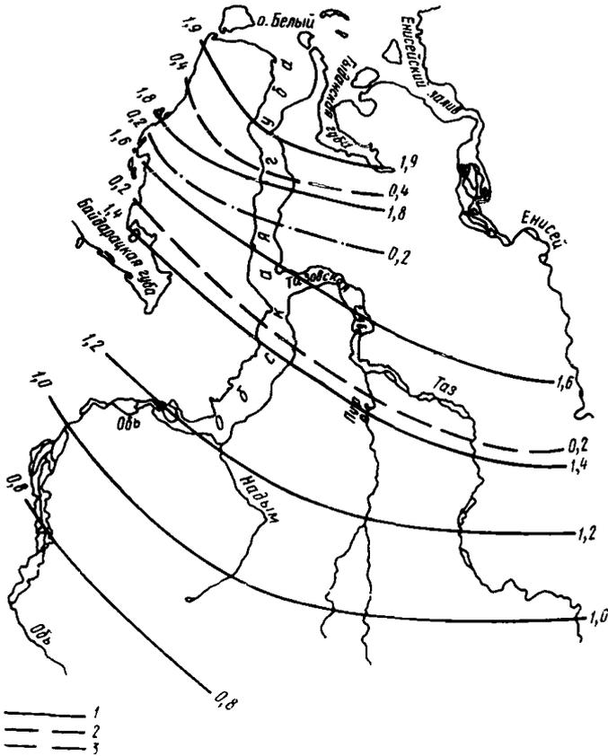
Рис. 10. Критическая глубина водоемов при различном термическом сопротивлении снежного покрова  $R_{сн}$ ,  $\text{м}^2 \cdot \text{К}/\text{Вт}$  ( $\text{м}^2 \cdot \text{ч} \cdot \text{°C}/\text{ккал}$ )
