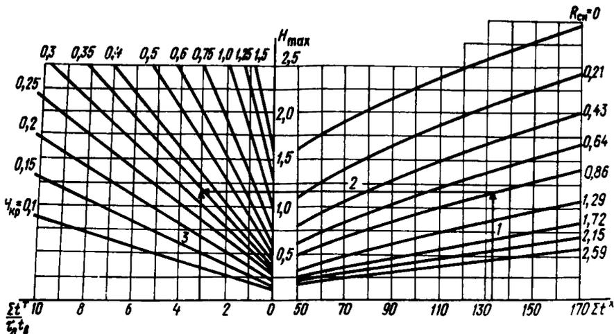
Рис. 6. Номограммы для расчета критической глубины водоема
