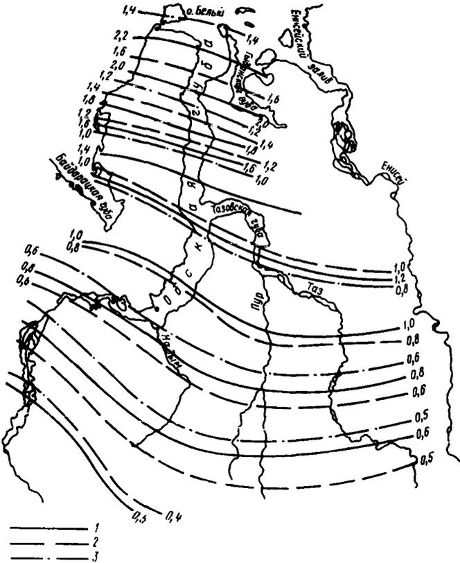
Рис.8. Критическая мощность снежного покрова при различном термическом сопротивлении напочвенного растительного покрова в летний  $R_A$  и зимний  $R_3$  периоды
