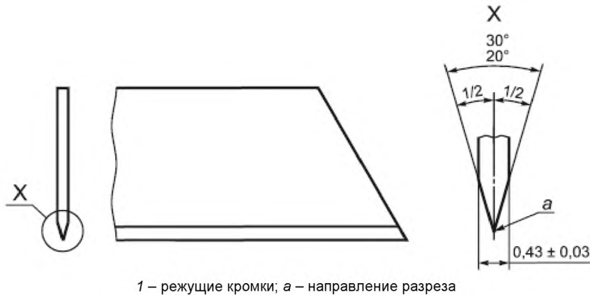
Рисунок 1 – Однолезвийный режущий инструмент
