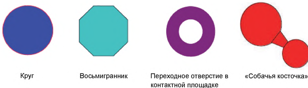
Рисунок 1 – Формы контактных площадок матричных посадочных мест
