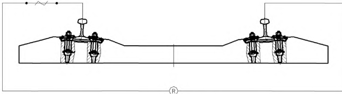
Рисунок 6 – Схема измерения электрического сопротивления
