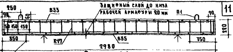
Места опирания при Разрзе 1-1 складировании и транспортировке
