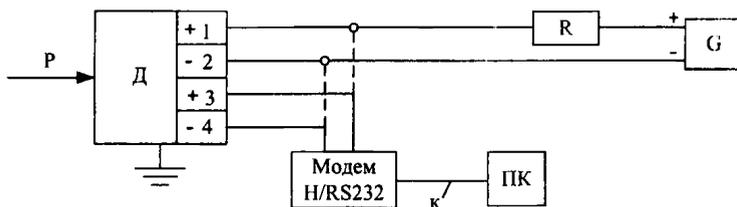
Модем – устройство связи и преобразования сигналов HART/RS232;
