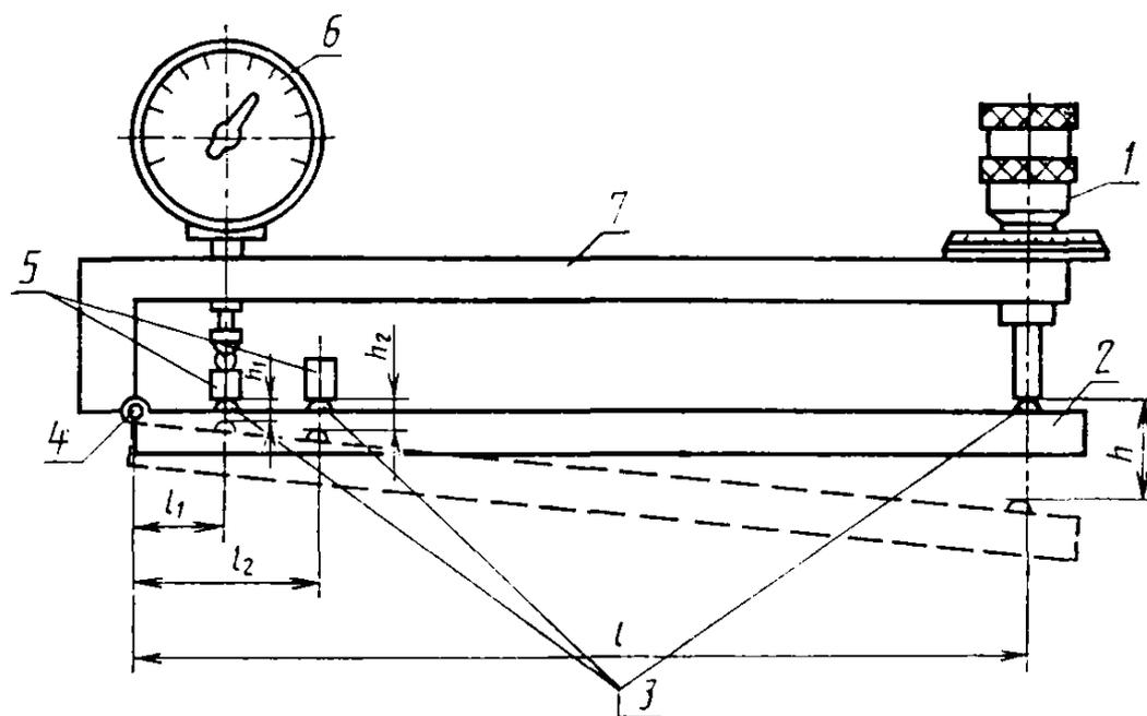
1—винт измерительный; 2—рычаг; 3—шариковые контакты; 4—беззазорный шарнир (пружина); 5—промежуточные плоскопараллельные элементы; 6—измерительная головка; 7—основание
