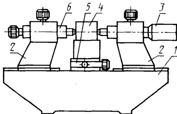
1—основание с направляющей; 2—кронштейн с посадочным диаметром 28H7; 3—поверяемая головка; 4—концевые меры длины; 5—стол; 6—пиноль
