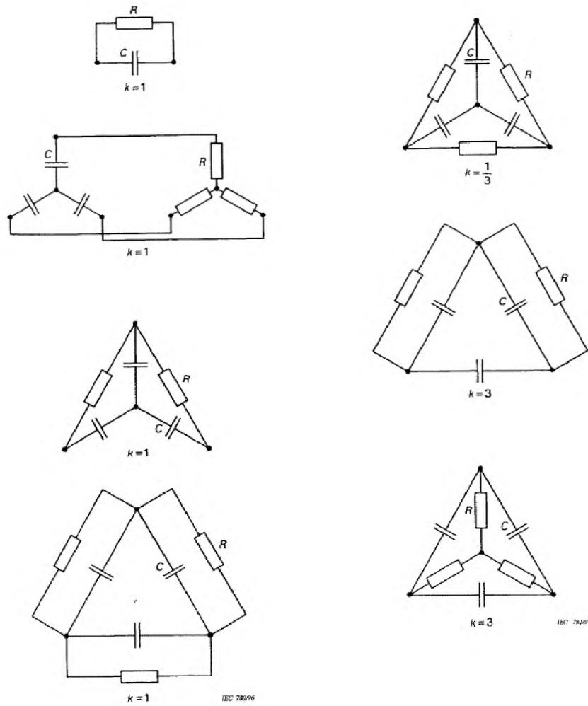
Рисунок B.1 — Значения  $k$  в зависимости от метода соединения резисторов с блоками конденсаторов
