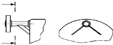
Рисунок 20 — Типовая конструкция ребер жесткости
