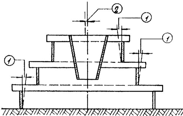
Допуски при установке опалубки фундамента в соответствии с требованиями СП 70.13330.
