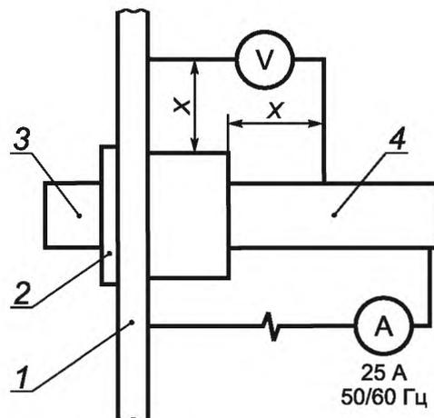
$X = (12 \pm 2)$  мм; 1—3 — миллиметровая стальная пластина; 2 — дополнительная натяжная гайка; 3 — концевая трубная арматура, прикрепленная к пластине сквозным болтом или на резьбе самой арматуры; 4 — труба
