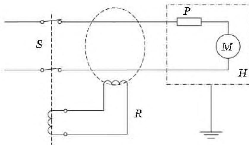
S — источник питания; H — корпус; R — защитное устройство с остаточным током ( $I_{\Delta n} = 30 \text{ мА}$ ); P — устройство тепловой защиты двигателя (внешнее и внутреннее), если имеется; M — двигатель
