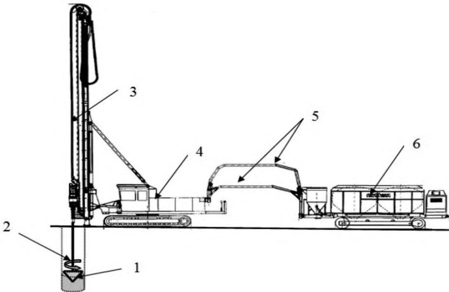
1 – конус; 2 – шнековый смеситель; 3 – штанга; 4 – базовая буровая машина;
