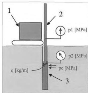
1 – буровая машина; 2 – штанга; 3 – свая из укрепленного грунта;
