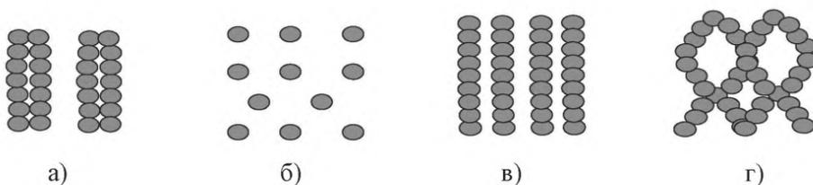
а) сваи-блоки; б) одиночные сваи; в) сваи-стенки; г) фигурные сваи-стенки
