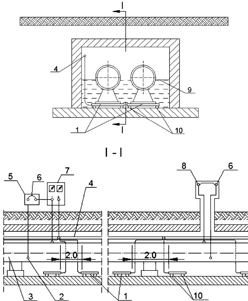
1 – электроды А3 стержневого типа; 2 – вспомогательный электрод; 3 – трубопровод;
