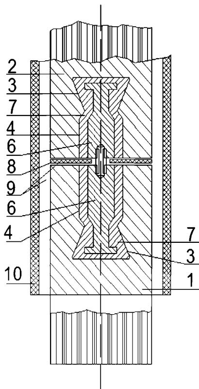
1, 2 – железокремнистые электроды; 3, 4 – глухие отверстия; 5 – стальная шпилька;
