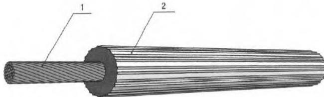
1 – медный или стальной токопровод; 2 – рабочая оболочка из электропроводного эластомера с удельным объемным электросопротивлением в диапазоне 0,5 – 5,0 Ом·м
