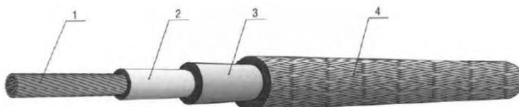
1 – медный или стальной токопровод; 2 – токозадающая оболочка из электропроводного эластомера с удельным объемным электросопротивлением в диапазоне 0,5 – 3000 Ом·м;
