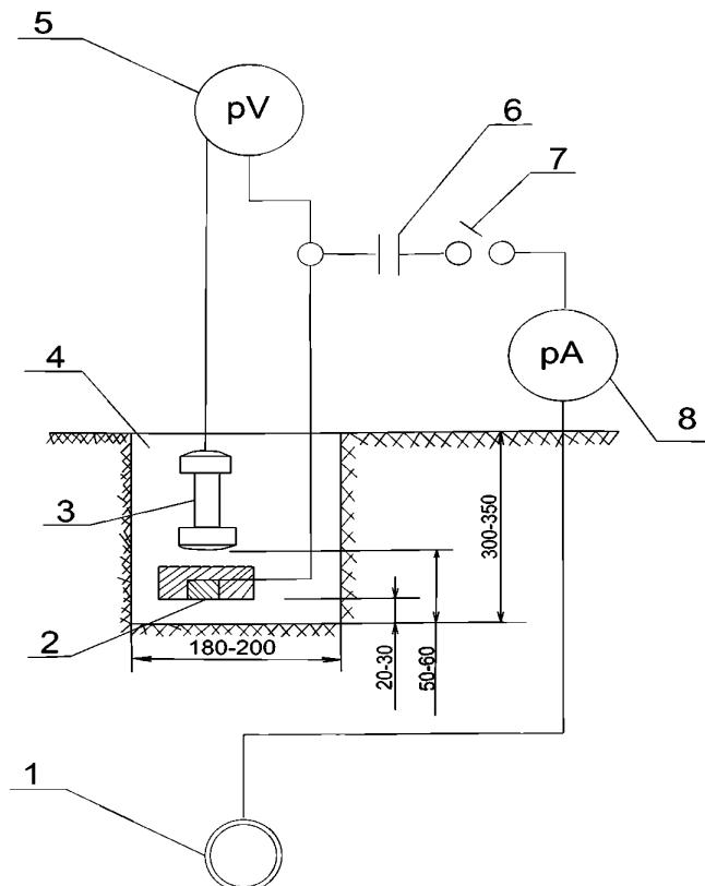
1 – трубопровод; 2 – датчик потенциала; 3 – переносной медносульфатный электрод сравнения;
