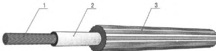
1 – медный или стальной токопровод; 2 – токозадающая оболочка из электропроводного эластомера с удельным объемным электросопротивлением в диапазоне 0,5 – 3000 Ом·м;
