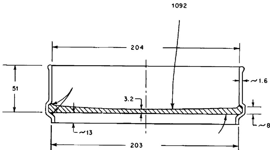
Примечание — Все размеры указаны в мм; размер “1092” соответствует радиусу кривизны; для изготовления дна поддона можно использовать любой из перечисленных сплавов:
