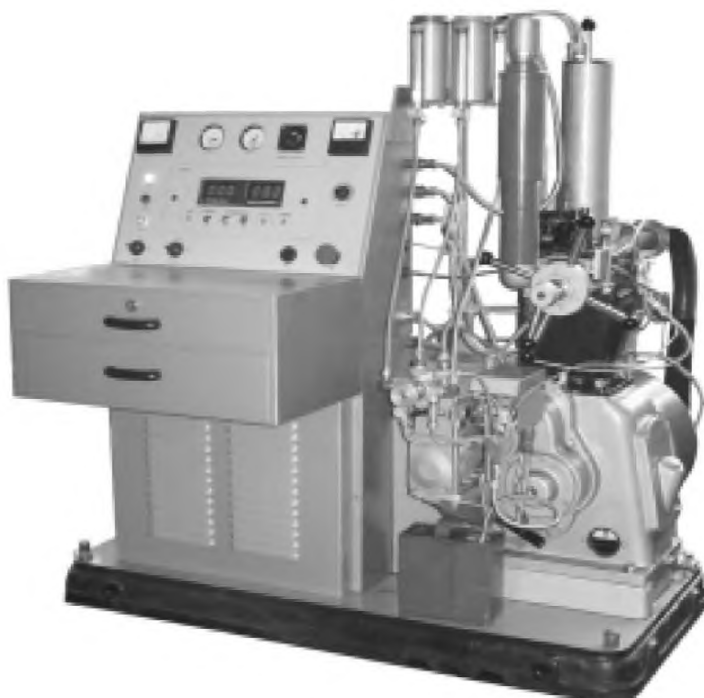
Рисунок 2 – Установка ИДТ-90 для определения цетанового числа
