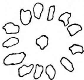
Рисунок 2 – Типичная форма факела распыла
