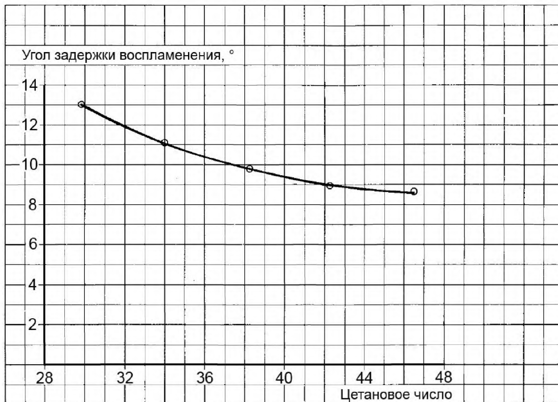
Рисунок Г.4.1 – Зависимость угла задержки воспламенения от цетанового числа
