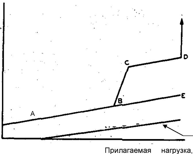
АВЕ – линия компенсации; В – последняя нагрузка без схватывания;
