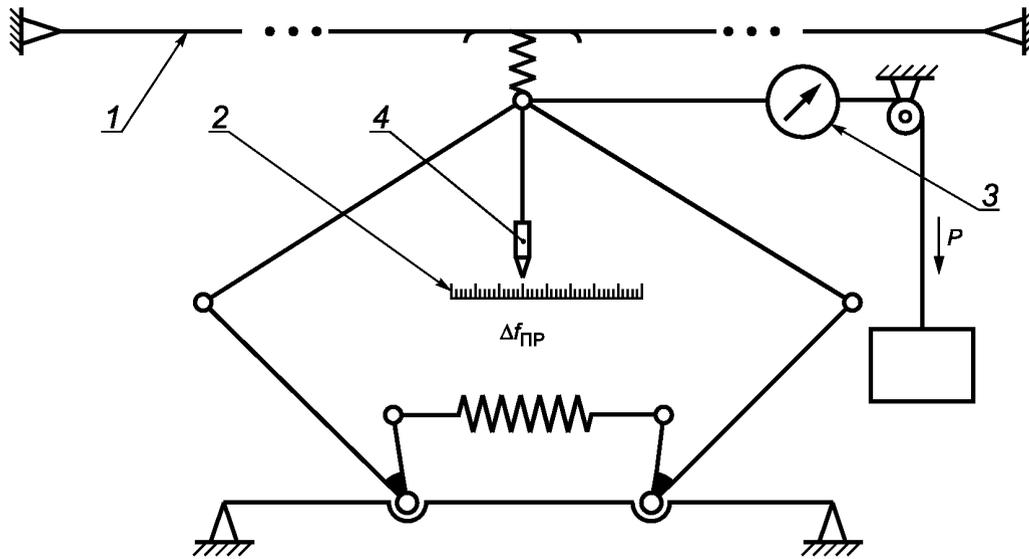
1 — контактный провод; 2 — измерительная линейка; 3 — динамометр; 4 — отвес
