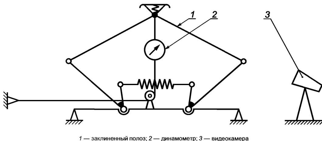
Рисунок 10 — Схема для определения вертикальной составляющей аэродинамической силы
