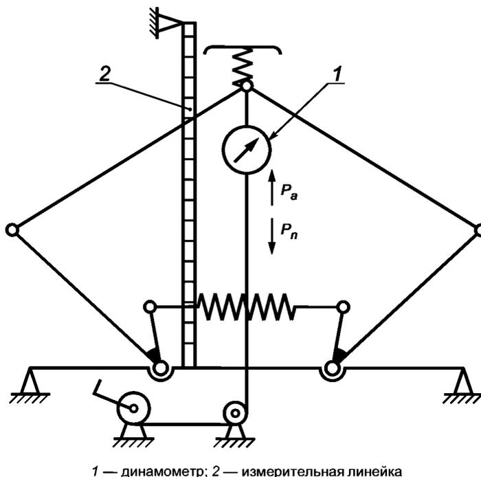
Рисунок 2 — Кинематическая схема для снятия статической характеристики
