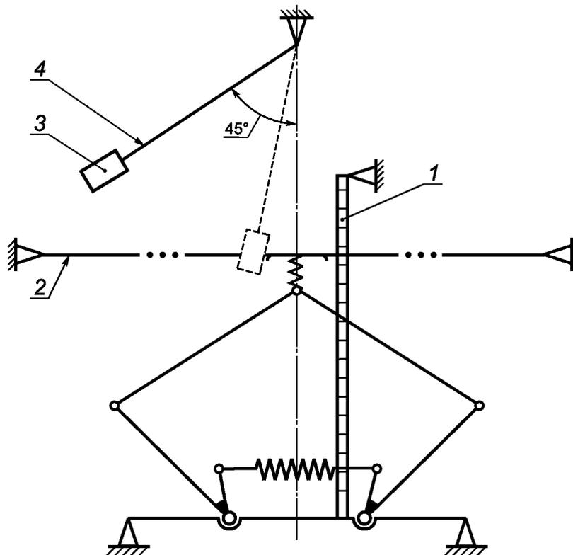
1 — измерительная линейка; 2 — контактный провод; 3 — груз; 4 — тросик
