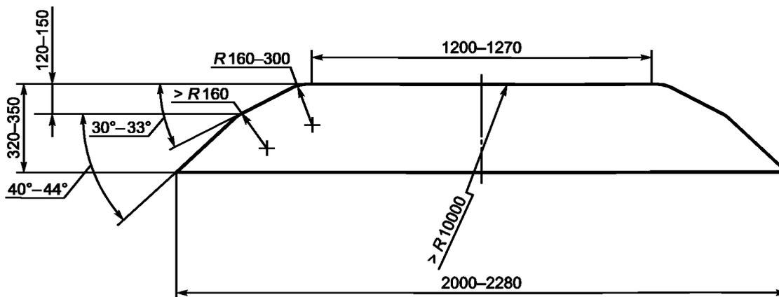
Рисунок 1 — Конфигурация и размеры полозов
