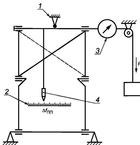
1 — контактный провод; 2 — измерительная линейка; 3 — динамометр; 4 — отвес
