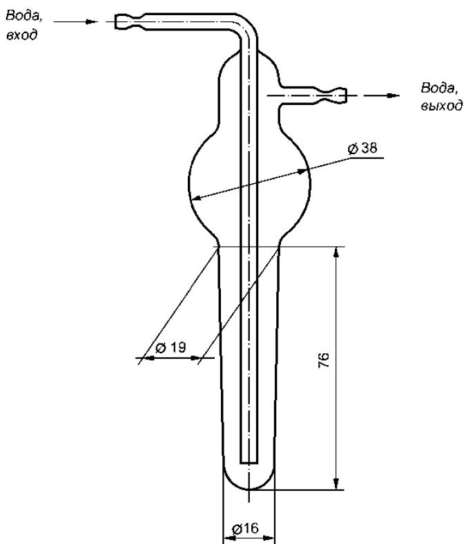
Рисунок 2 — Пальчиковый холодильник для определения форм серы в углях
