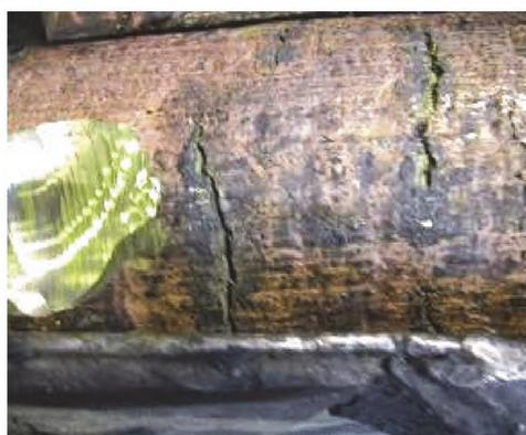
Трещина поперечная на слитке
