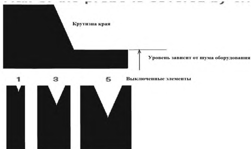
Рисунок D.4 – Интерпретация имитации неисправности датчика, когда его половина покрыта пятью слоями 50-миллиметровой матерчатой ленты
