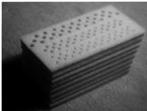
Рисунок А.2а) – Группа слоев ТИМ, содержащая попеременно слои пустот и слои затухания из пенополиуретана (поролон)
