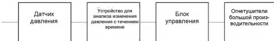
Рисунок A.2 – Блок-схема функционирования системы
