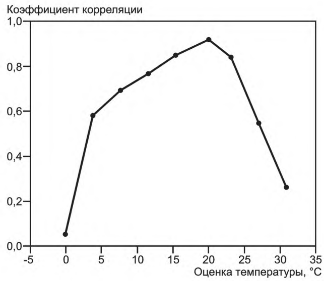
Рисунок 23 — Коэффициент корреляции, соответствующий паре оценок \hat{\theta}_j и \hat{\theta}_{10} температур \theta_j и \theta_{10} = 20\text{ °C} (9.5.3.7)
