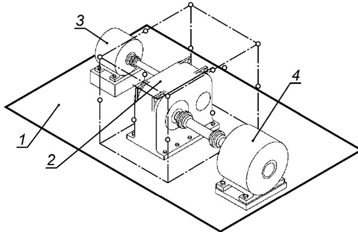
1 — пол; 2 — редуктор; 3 — двигатель; 4 — нагрузочное устройство
