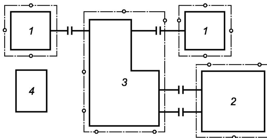
1 — двигатель; 2 — смеситель; 3 — редуктор; 4 — система смазки
