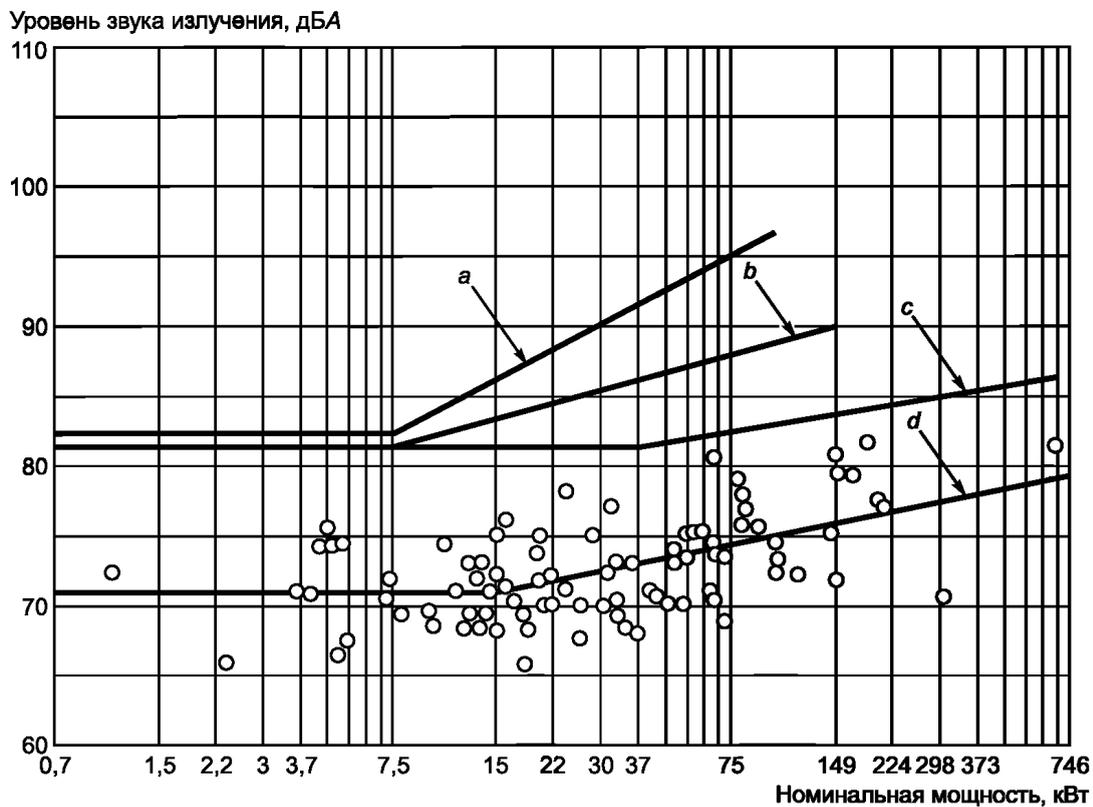
*a* — типичный максимум: мотор-редуктор (с закрытым охлаждаемым вентилятором двигателем, 1800 об/мин); *b* — типичный максимум: мотор-редуктор (с каплезащищенным двигателем, 1800 об/мин); *c* — типичный максимум: цилиндрический понижающий и повышающий редуктор по развернутой схеме (без двигателя); *d* — среднее значение: цилиндрический понижающий и повышающий редуктор по развернутой схеме (без двигателя)
