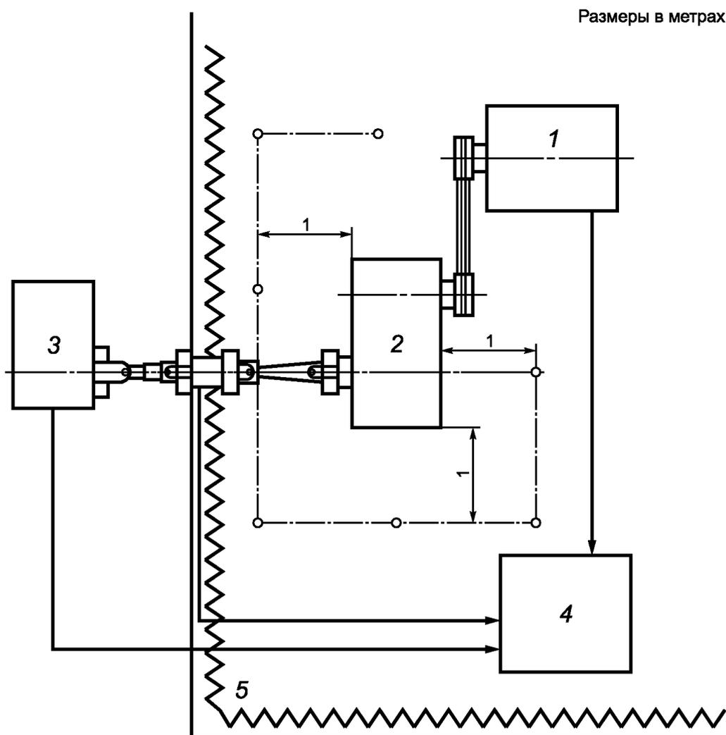
1 — двигатель; 2 — редуктор; 3 — нагрузочное устройство; 4 — устройство контроля крутящего момента;
