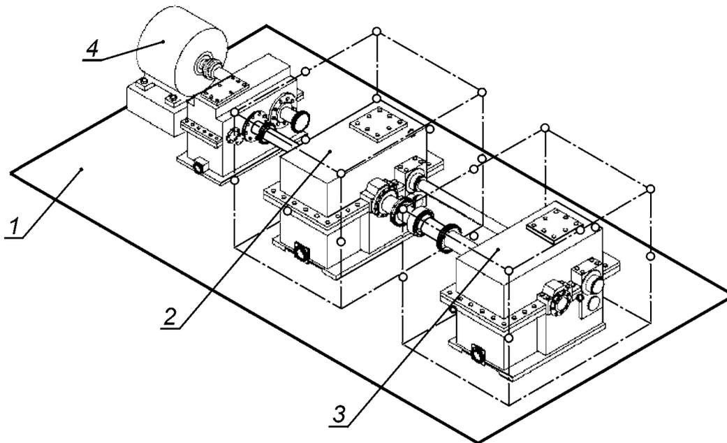
1 — пол; 2 — первый редуктор; 3 — второй редуктор; 4 — двигатель
