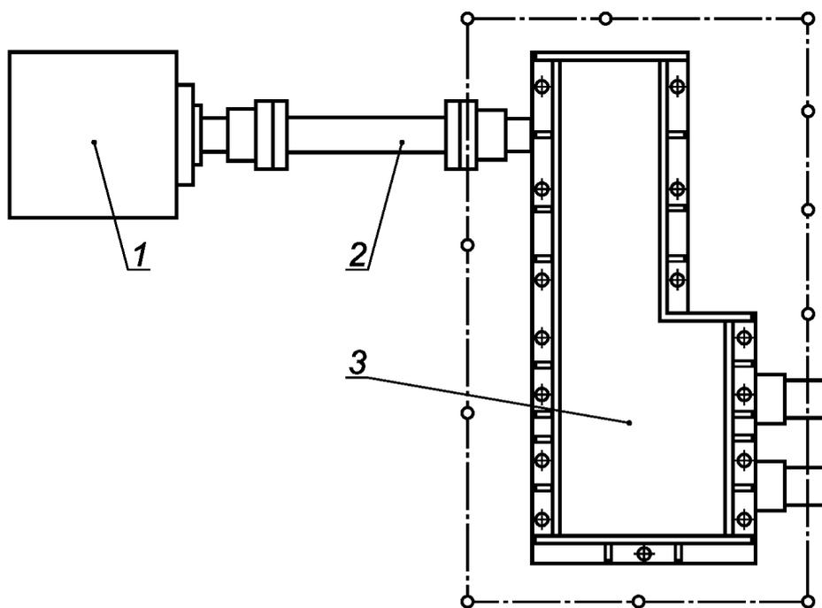
1 — двигатель; 2 — муфта; 3 — испытуемый редуктор (смеситель для резиновых смесей)
