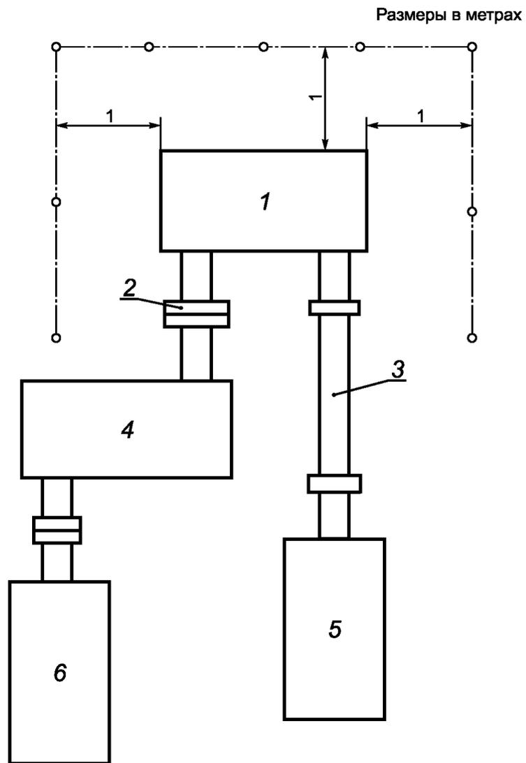
1 — испытуемый редуктор; 2 — зубчатая муфта; 3 — отбалансированный карданный вал; 4 — повышающий редуктор; 5 — приводной двигатель; 6 — электронагружатель
