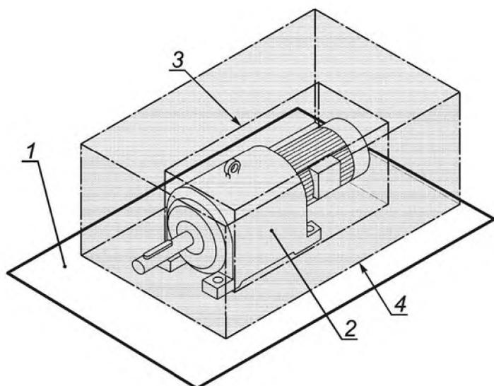
1 — пол; 2 — редуктор; 3 — огибающий параллелепипед; 4 — измерительная поверхность
