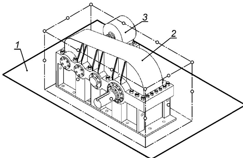
1 — пол; 2 — редуктор; 3 — двигатель
