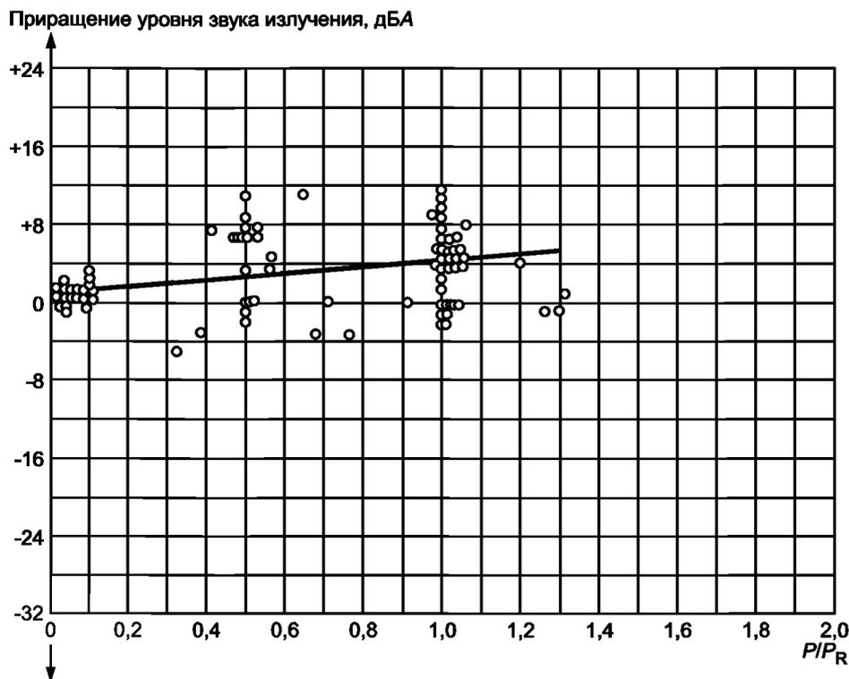
По данным изготовителя, для косозубых, шевронных, конических передач с круговым зубом и червячных зубчатых передач приращение уровня звука излучения  $\Delta L_{pA}$  рассчитывают по формуле
