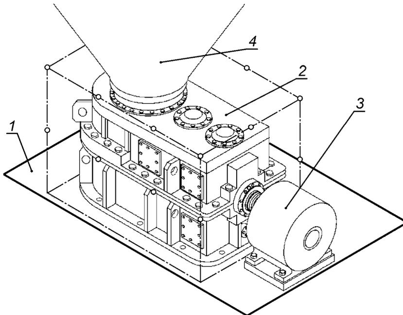
1 — пол; 2 — редуктор; 3 — двигатель; 4 — нагрузочное устройство
