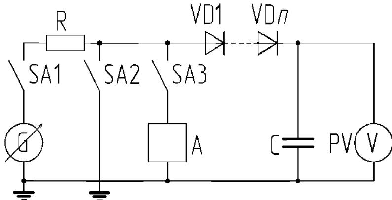
G – источник напряжения переменного тока амплитудным значением до 2,5 кВ частотой
