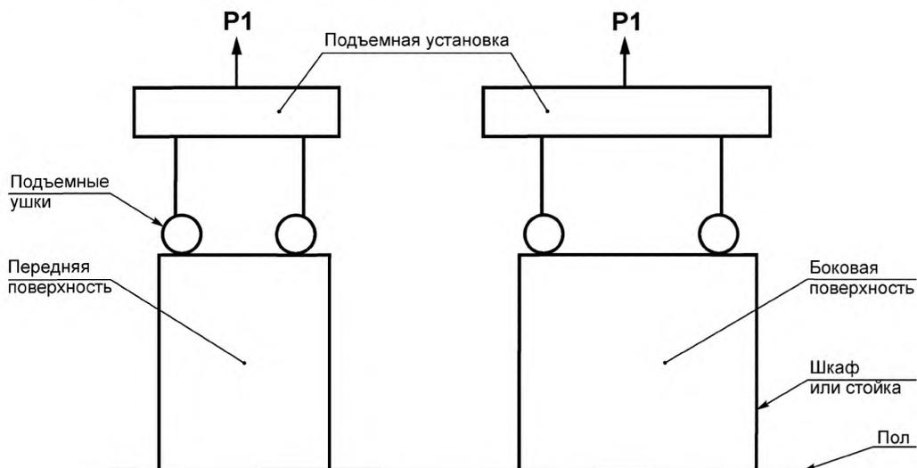
Рисунок 1 — Испытание на подъем для шкафов и стоек
