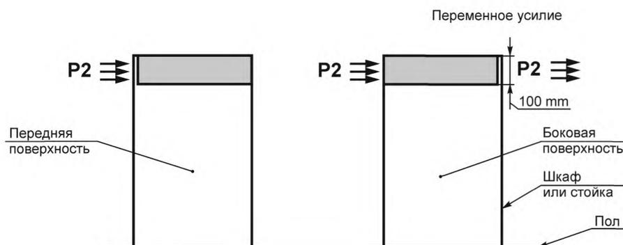
Рисунок 2 — Испытание шкафов и стоек на жесткость
