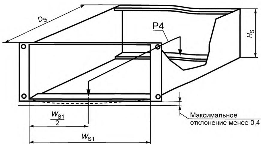
Примечание – Испытания на нагрузку в одной точке должны проводиться равномерно для всех нижних горизонтальных деталей вдоль осевой линии блочного каркаса, как показано на рисунке 7 и в таблице 6.
