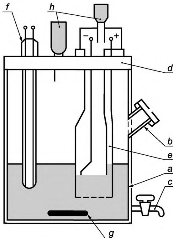
*a* — сосуд для титрования (анодное отделение); *b* — ответвление для ввода пробы; *c* — сливной кран; *d* — политетрафторэтиленовая крышка; *e* — генератор в сборе (катодное отделение); *f* — двойной платиновый электрод для измерения потенциала; *g* — магнитная мешалка с политетрафторэтиленовым покрытием; *h* — осушающие трубки
