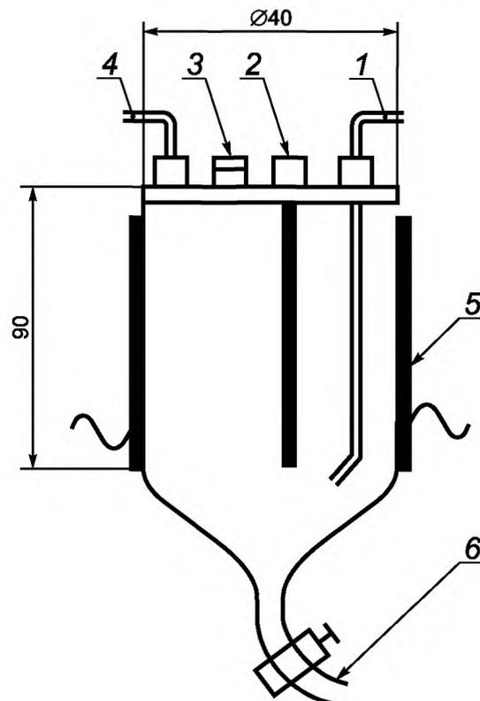
1 — входная трубка для подачи азота; 2 — термопара; 3 — закрытый мембраной вход для ввода пробы; 4 — выходная трубка для подачи выпаренной воды в токе азота; 5 — нагреватель; 6 — сливной кран
