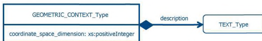
Рисунок 105 — Структура геометрического контекста
