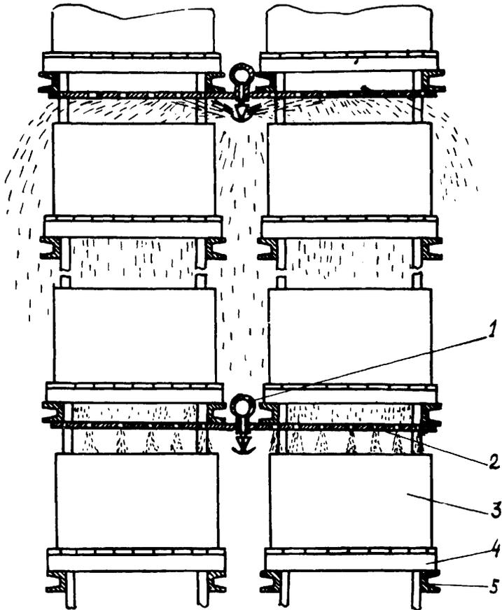
Рис. 2. Примерная схема размещения оросителей типа СВ во внутрительном пространстве спаренного стеллажа:
