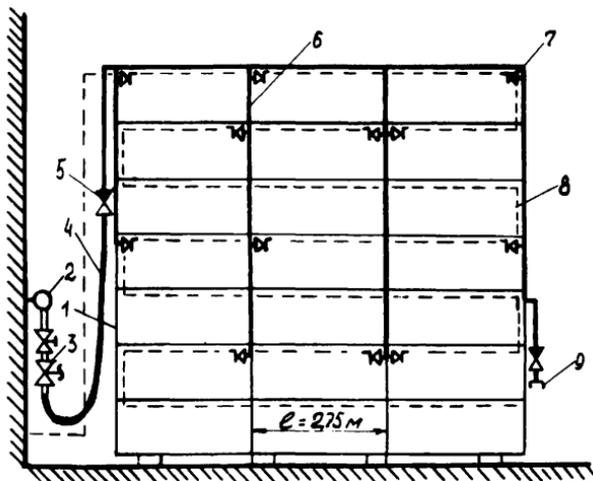
Рис. 5. Схема компоновки секции АУП в передвижном стеллаже:
