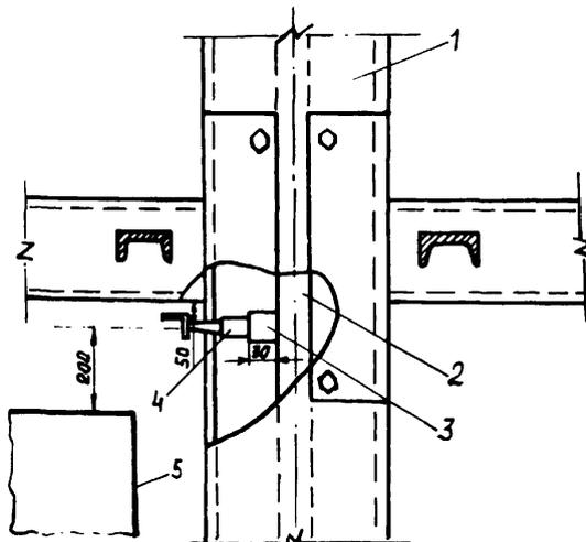
Рис. 6. Схема размещения оросителя ДНо-12 внутри стоек стеллажа:
