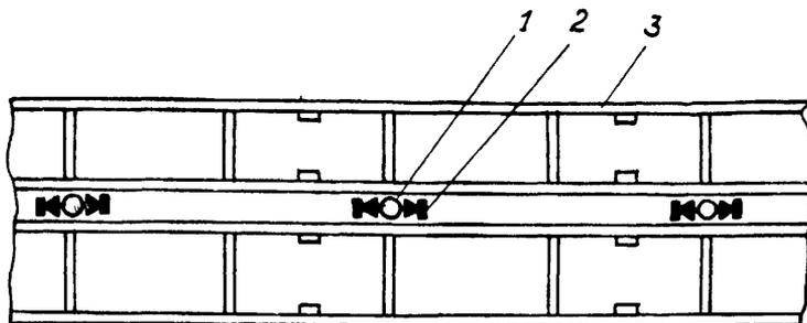
Рис. 4. Схема установки оросителей типа СН на распределительных трубопроводах во внутрискелажном пространстве (вид сверху):
