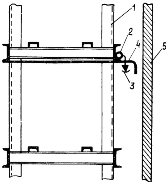
Рис. 3. Примерная схема размещения оросителей типа СВ в одинарном стеллаже:
