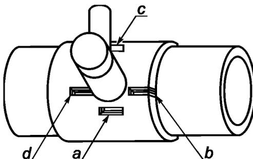
Рисунок Б.3 — Отбор образцов (от *a* до *d*) в случае седелок для испытаний на сдвиг со скручиванием: вручную, механизированным методом и радиальным расплаиванием
