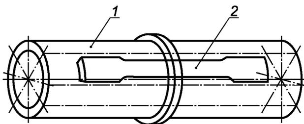
1 — патрубок со сварным соединением; 2 — расположение образцов
