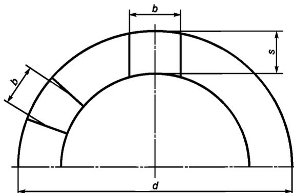
Рисунок 11 — Способы вырезания образцов из трубы
