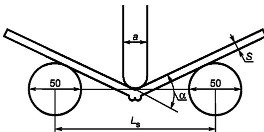
$S$  — толщина образца;  $\alpha$  — угол изгиба;  $a$  — толщина пуансона, конец имеет форму полукруга;
