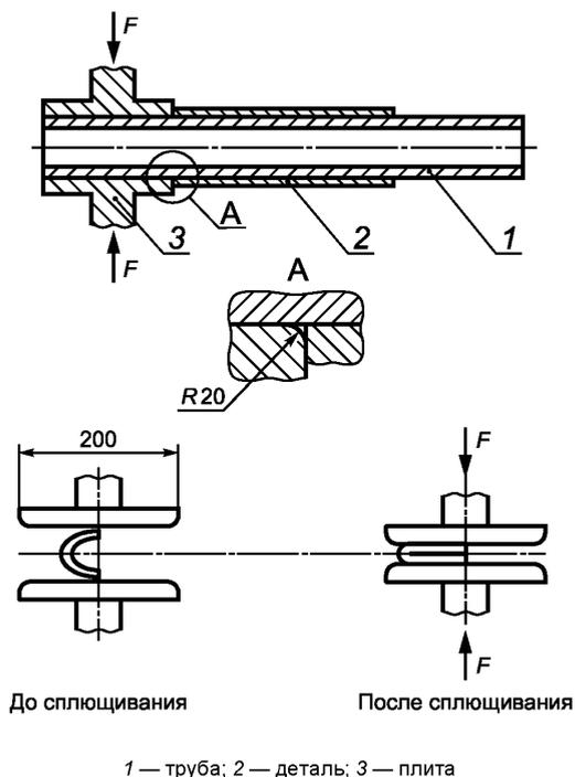
Рисунок 16 — Расположение образцов между плитами испытательной машины
