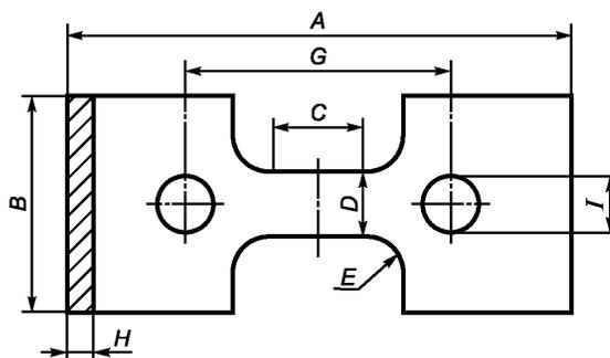
Рисунок 4 — Испытуемый образец, тип 3
