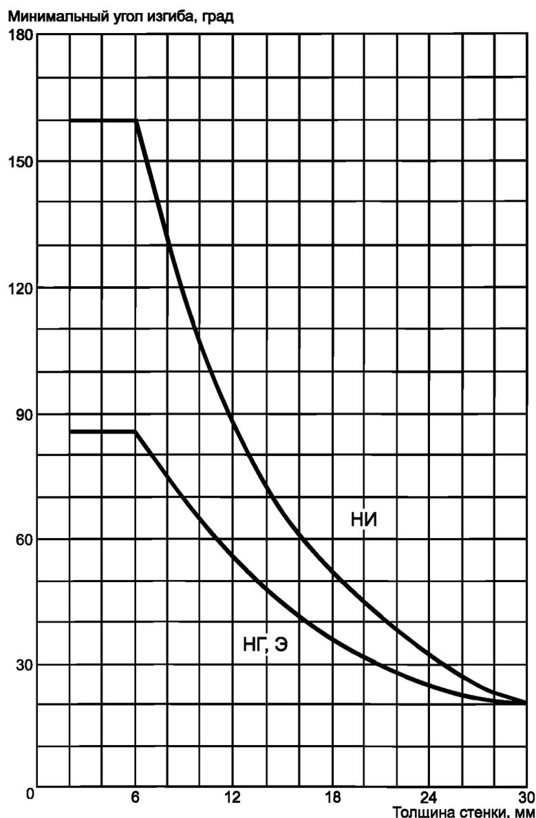
Рисунок В.1 — Минимальный угол изгиба для ПНД (ПЭ 63, ПЭ 80, ПЭ 100) в зависимости от толщины для разных методов сварки [верхняя кривая — для сварки нагретым инструментом встык (НИ), нижняя — для прутковой газовой сварки и экструзионной сварки (НГ, Э)]
