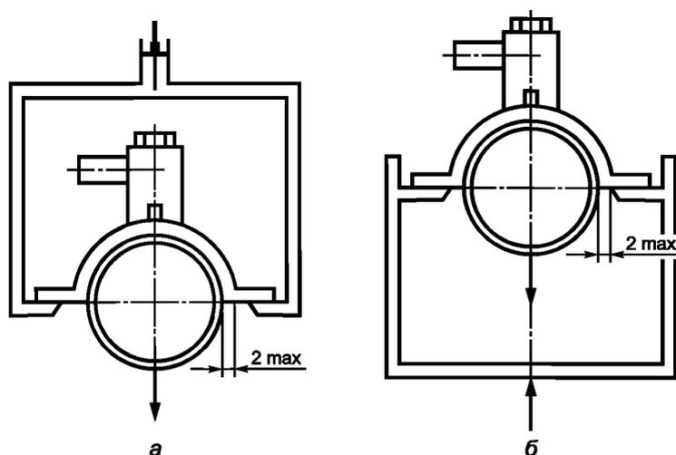
а — при растяжении; б — при сжатии
