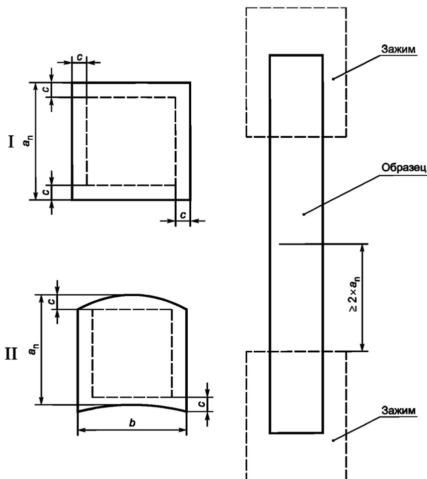
$a_n$  — толщина образца;  $b$  — ширина образца;  $c$  — глубина надреза —  $(17 \pm 2) \% a_n$ ; I — образец с квадратным сечением; II — образец с неквадратным сечением (например, из стенки трубы). Предпочтительно, если  $a_n = b$
