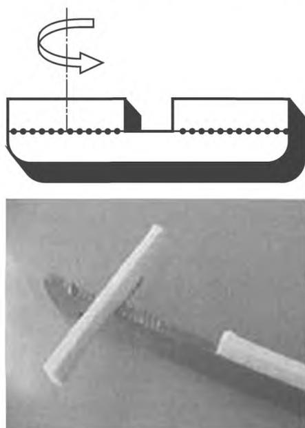
Рисунок Б.4 — Сдвиг кручением вручную
