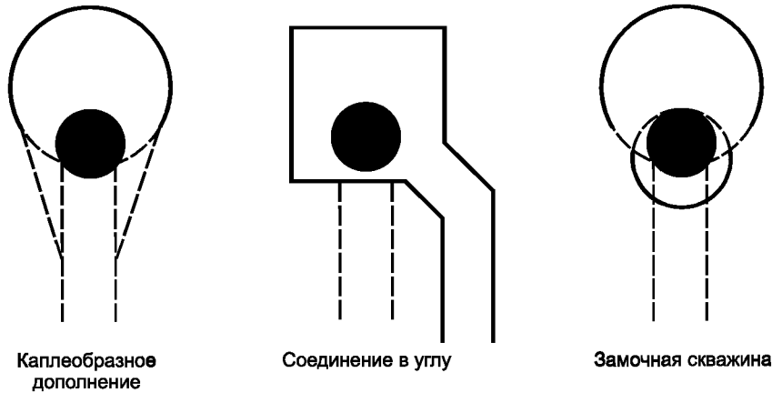
Рисунок 17 — Примеры измененных соединений проводника и контактной площадки
