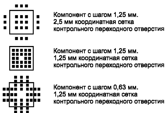
Рисунок 25 — Принципы расположения контрольных переходных отверстий по координатной сетке
