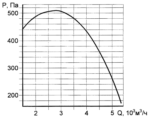
Рисунок 6 – Аэродинамическая характеристика вентилятора ВКРВ 3,15ДУ-4
