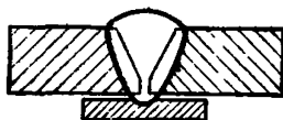
Рис. 28. Соединение сты- ковое со скосом кромок одностороннее на остаю- щейся подкладке С 19
