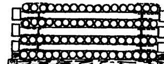
Формирование труб диаметром до 200 мм в штабель «клеткой»
