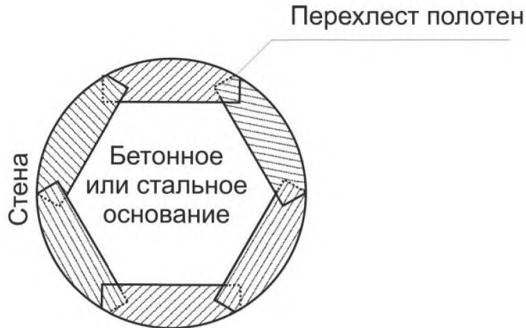
Рисунок А.1 – Укладка стеклянного мата первого слоя в примыканиях
