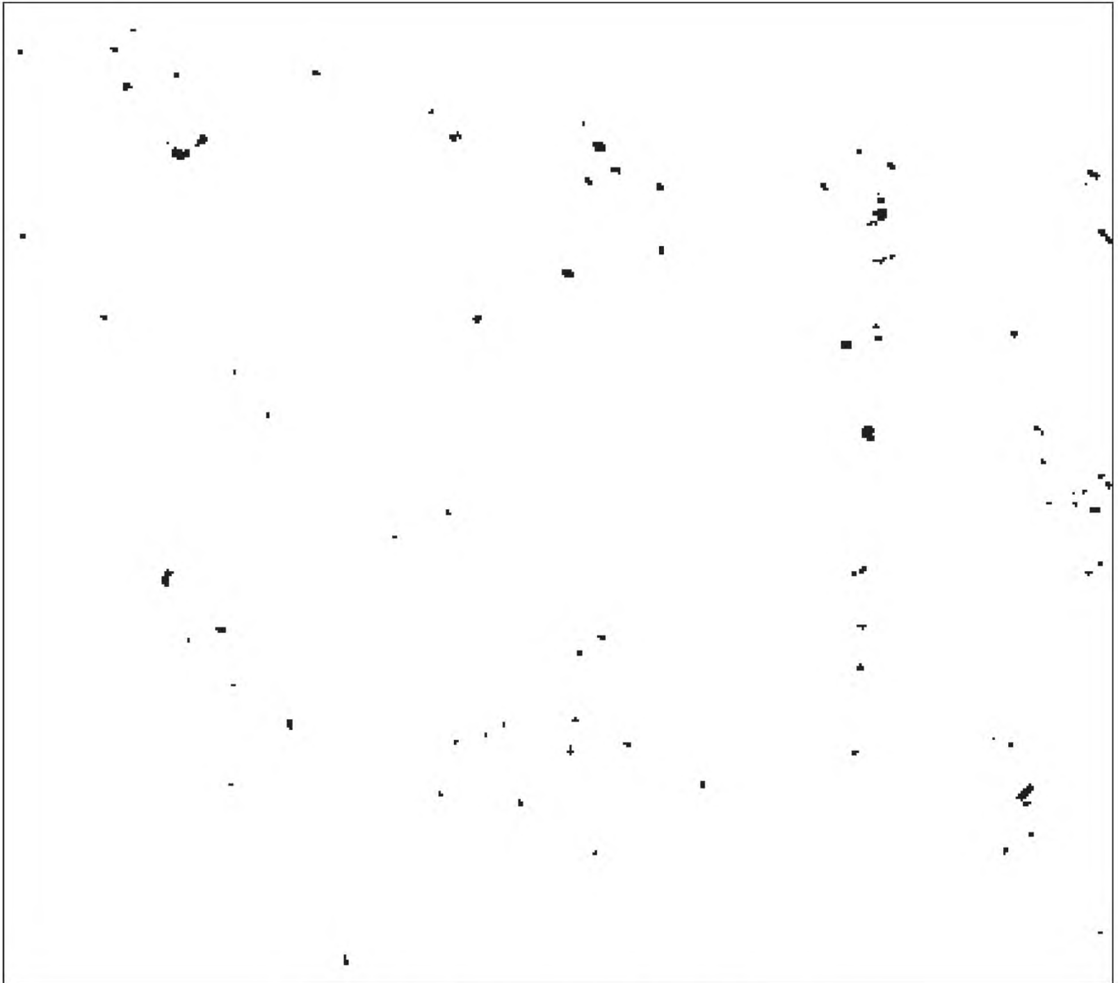
Рисунок Ж.2 — Коррозия металла, балл К2 (или R2)
