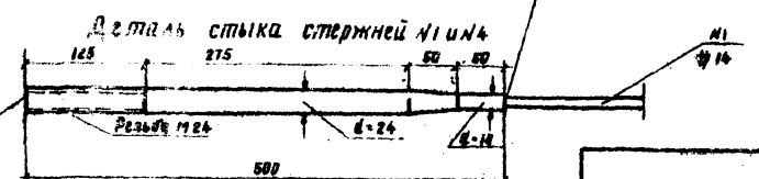
Контактная сварка встык
