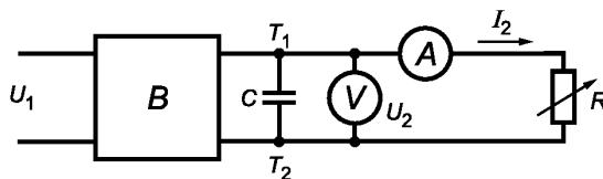
$U_1$  — напряжение питания;  $U_2$  — выходное напряжение;  $I_2$  — выходной ток;  $A$  — амперметр;  $B$  — зарядное устройство батарей;  $V$  — вольтметр;  $R$  — переменный резистор;  $T_1$  и  $T_2$  — выходные зажимы зарядного устройства батарей;  $C$  — конденсатор емкостью  $E$  в фарадах, рассчитываемой по формуле
