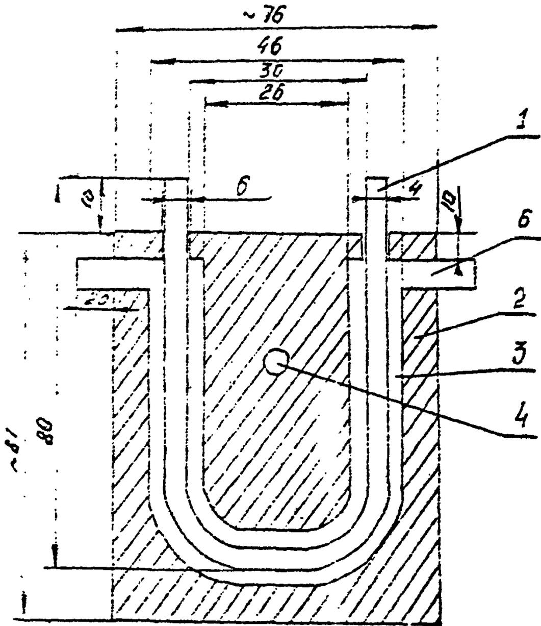
1 - колонка обогатительная; 2 - корпус блока; 3 - канал для колонки; 4 - отверстие для крепежного болта; 5 - прокладка; 6 - боковые отверстия.
