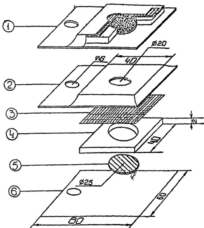
Рис. 8. Пассивный дозиметр -П- I
