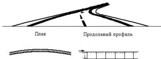
Рис. 13.6 Ухудшение зрительной плавности при коротких прямых вставках между направленными в одну сторону кривыми в плане
