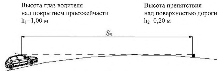
Рис. 15.1 Минимальное расстояние видимости по условию остановки на вершине вертикальной кривой
