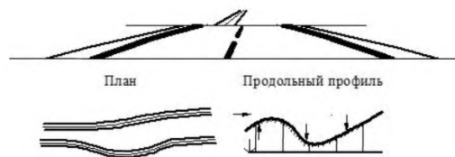
Рис. 13.19. Нарушение зрительной ясности дороги из-за расположения двух кривых в плане в пределах одной вертикальной кривой
