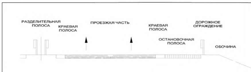
Рис 14.1 Основные элементы поперечного профиля дороги.
