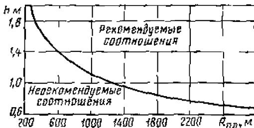
Рис. 13.1. Соотношения радиусов кривых в плане при различной высоте глаз водителей над покрытием проезжей части кривой в плане, обеспечивающие зрительную плавность дороги
