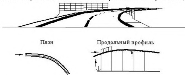
Рис. 13.17. Улучшение вида дороги за счет расположения моста на кривой в плане большого радиуса.
