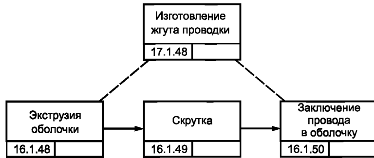
Рисунок В.5 — Блок-схема процесса изготовления жгута проводки [8]
