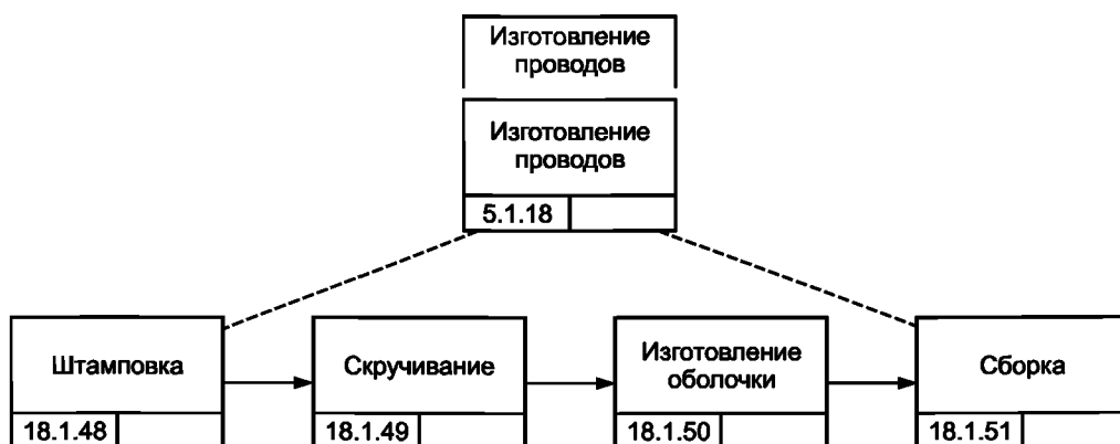
Рисунок С.6 — Процесс изготовления проводов 350-Wire
