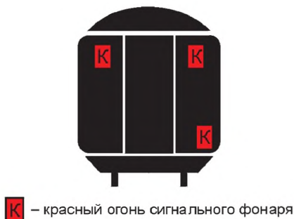
Рисунок 1 — Размещение сигнальных фонарей на торцевых стенах вагона
