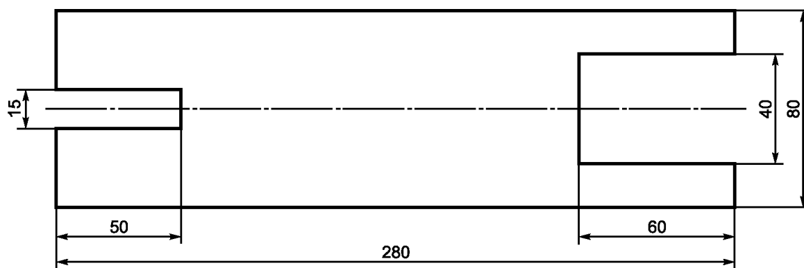
в) Стальная пластина (толщина пластины 6 мм)
