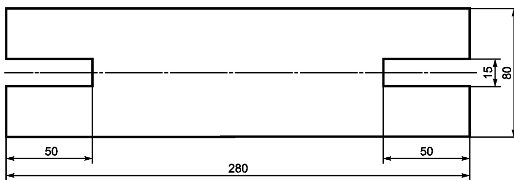
в) Стальная пластина (толщина пластины 6 мм)
