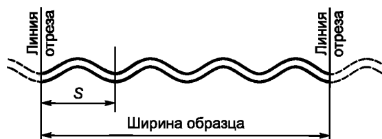
Рисунок 19 — Схема обрезки целых листов перед испытанием
