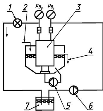
1 – регулятор давления; 2 – свежеприготовленный диализирующий раствор; 3 – гемодиализатор; 4 – переток диализирующего раствора в слив; 5 – циркуляционный насос диализирующего раствора; 6 – перфузионный насос; 7 – резервуар для испытательного раствора
