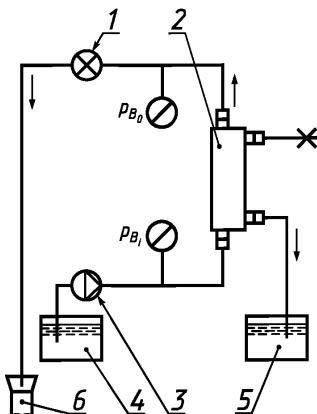
1 – регулятор давления; 2 – гемодиализатор, гемофильтр или гемоконцентратор; 3 – перфузионный насос; 4 – резервуар для испытательного раствора; 5 – фильтрат; 6 – слив
