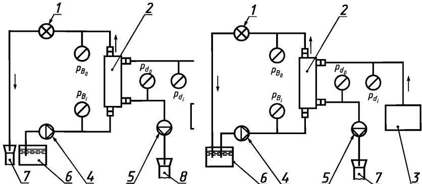
1 – регулятор давления; 2 – гемодиализатор; 3 – система подачи диализирующего раствора; 4 – перфузионный насос; 5 – источник вакуумметрического давления диализирующего раствора; 6 – резервуар испытательного раствора; 7, 8 – слив
