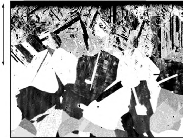
Рисунок 10 — Пример образования эpsilon-мартенсита в обезуглероженной поверхностной зоне закаленной аустенитной марганцовистой стали, содержащей менее 0,5\% углерода (100 \times , травление 2 %-ным спиртовым раствором азотной кислоты в течение 5 с, а затем 20 %-ным водным раствором пиросульфита натрия в течение 20 с)
