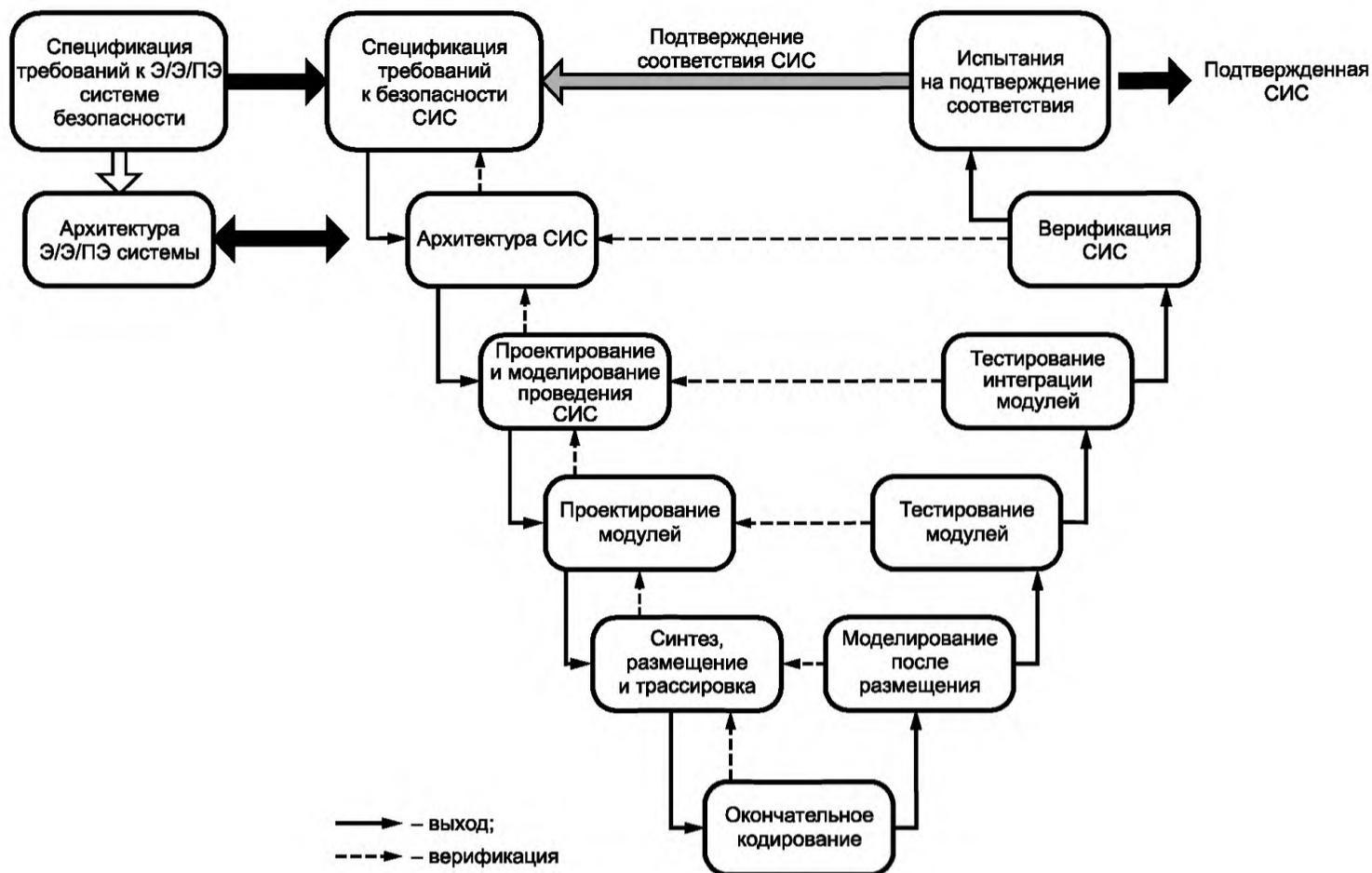
Рисунок 3 — Структура жизненного цикла разработки СИС (V-модель)
