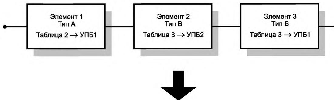
Э/Э/ПЭ подсистема, связанная с безопасностью, соответствует требованиям к архитектуре для функции безопасности с УПБ 1
