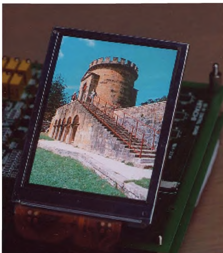
Рисунок 6 — OLED дисплей с 3,5-дюймовой QVGA-панелью
