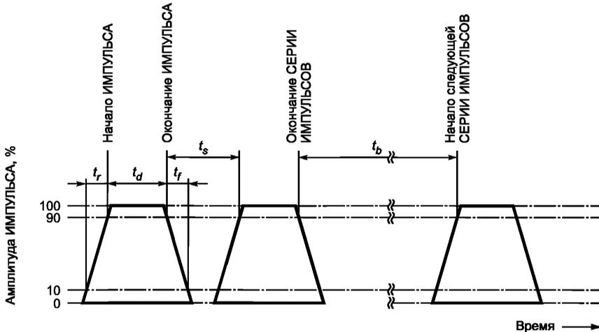
Рисунок 201 – Пояснение временных характеристик звуковых СИГНАЛОВ ОПАСНОСТИ
